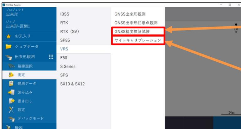
※注意：GNSS 観測では、事前にGNSS 精度検証試験を行い、対象受信機の精度が適切か確認しておいてください。
